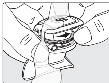
Retourner la tête de valve pour un meilleur nettoyage
